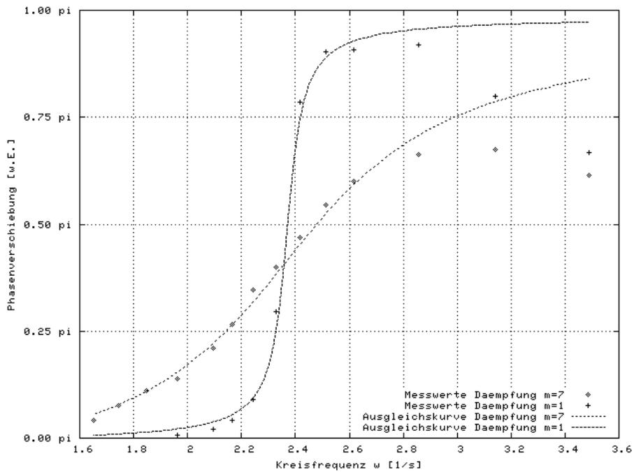
Abbildung 2: Resonanzkurve der Phasenverschiebung  $\Phi(\omega)$
