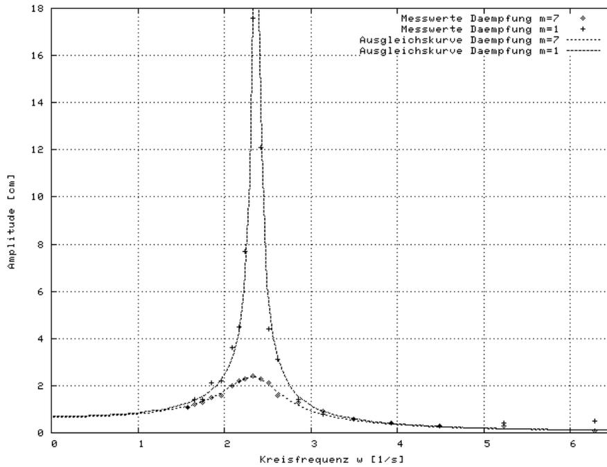
Abbildung 1: Resonanzkurve der Amplitude  $A(\omega)$
